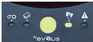
Il est recommandé de nettoyer l'imprimante à chaque changement de ruban. Badgy propose également un message d'alerte pour signaler qu'un nettoyage est nécessaire. La diode de nettoyage du panneau de contrôle s'allume à chaque cycle de 400 cartes insérées.
