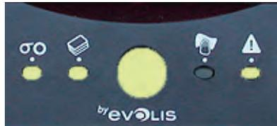
Affichage du panneau de contrôle – PROBLÈME MÉCANIQUE – Les tâches sont interrompues.
